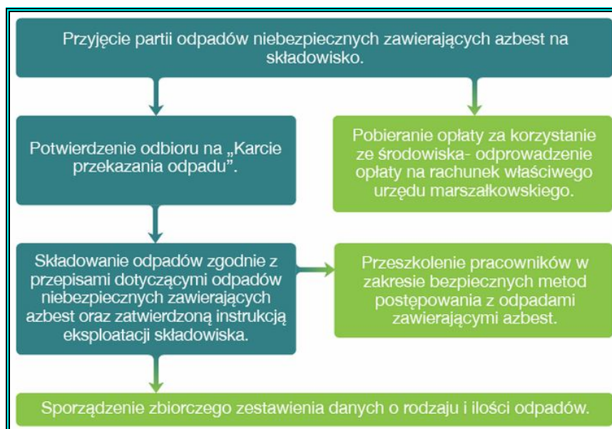
Ryc. 9. Procedura 6 - dotycząca składowania odpadów na składowisku przeznaczonym do wyłącznego składowania odpadów zawierających azbest lub innym, spełniającym odpowiednie warunki techniczne
